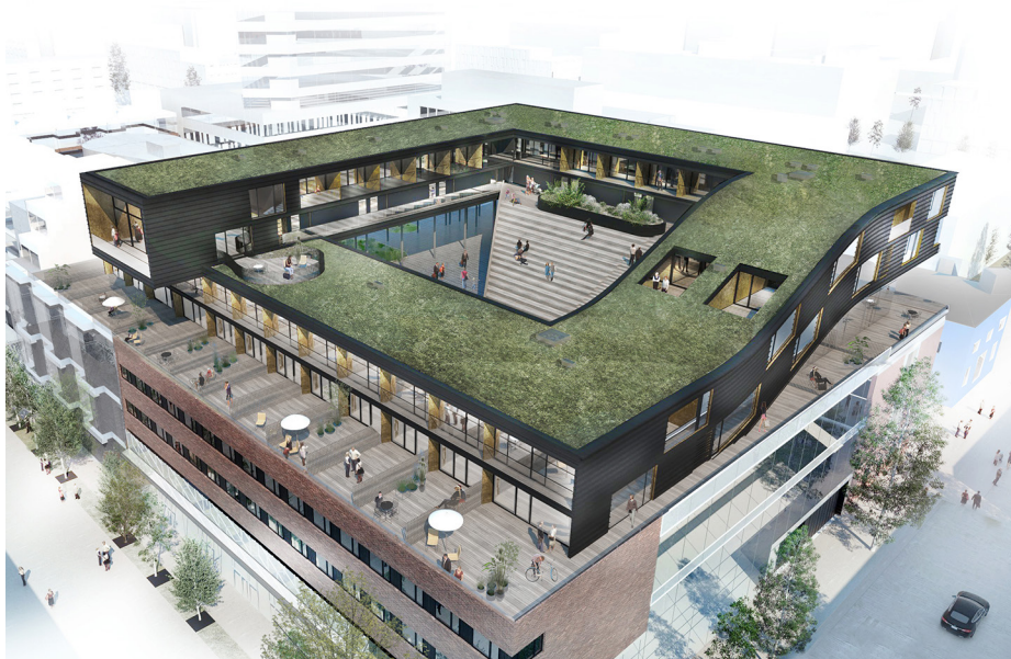
Brf Glitne, Umeå. Byggnadens fasad är beklädd med anodiserad aluminium, därunder ryms en stälförstärkt KL-träkonstruktion. Totalt innehåller byggnaden 47 lägenheter med fantastisk utsikt över Umeå. Sedumtaket tillför grönyta till staden.
